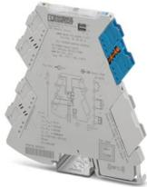
Ex i-NAMUR-Trennschaltverstärker zum Betrieb von Näherungsinitiatoren und Schaltern im Ex-Bereich. Die Signale werden über 2 Transistorausgänge (passiv) in den sicheren Bereich übertragen. Standardkonfiguration, Leitungsfehlererkennung, Safety Integrity Level (SIL, IEC 61508): 3, Push-in-Anschluss
