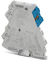
Ex i-NAMUR-Trennschaltverstärker zum Betrieb von Näherungsinitiatoren und Schaltern im Ex-Bereich. Die Signale werden über 2 Transistorausgänge (passiv) in den sicheren Bereich übertragen. Standardkonfiguration, Leitungsfehlererkennung, Safety Integrity Level (SIL, IEC 61508): 3, Schraubanschluss
