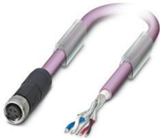
Bussystem-Kabel, 5-polig, PUR halogenfrei, violett RAL 4001, geschirmt, freies Leitungsende, auf Buchse gewinkelt M8, Kodierung: B, Kabellänge: 1,5 m, Steckverbinder ungeschirmt, kundenspezifische Variante
