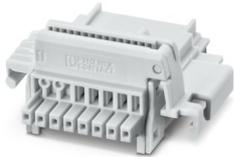
Tragschienen-Busverbinder, Farbe: lichtgrau, Nennstrom: 6 A, 4 A (parallele Kontakte) (serielle Kontakte), Bemessungsspannung (III/2): 32 V, Polzahl: 8, Artikelfamilie: TBUS8-25..., Rastermaß: 2,54 mm, Montage: Tragschienenmontage, Verriegelung: ohne, Befestigungsart: ohne, Verpackungsart: verpackt im Karton, Artikel mit vergoldeten Kontakten, Busstecker zur Verbindung mit Elektronikgehäusen, 4 Parallelkontakte/4 serielle Kontakte
