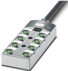
Verteilerbox, Anwendung: Standard, erweiterte Anforderungen, Anschlussart: M12-Buchse Metall / M12-Push-Pull-Buchse, Anzahl der Steckplätze: 8, Polzahl: 5, Kodierung: A, Steckplatzbelegung: doppelt, Statusanzeige: nein, Universal; Stammleitungsanschluss: Festanschluss 180°, PUR/PVC, Leitungslänge: 10 m, Schirmung: ja
