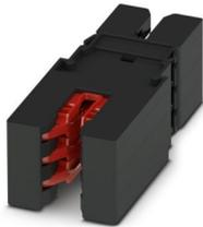
Steckverbinder, Artikelfamilie: BBC, Bauform: Steckverbinder, Farbe: schwarz, Polzahl: 1, Bemessungsspannung: 1500 V DC, Bemessungsstrom: 200 A, Anschlussart: Federkraftanschluss
