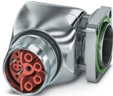
M23, Gerätesteckverbinder Vorderwand, Serie: SH, gewinkelt drehbar, geschirmt: ja, für Standard- und SPEEDCON-Verriegelung, Polzahl: 4+4+PE / 3+N+PE, Kontaktart: Buchse, Crimpanschluss, O-Ring axial, Flanschmaß: 26 mm x 26 mm
