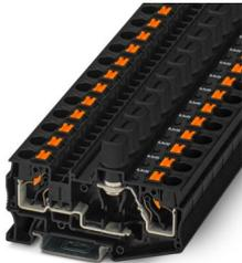
Sicherungsreihenklemme, Art der Sicherung: Glas / Keramik / ..., Sicherungstyp: G / 6,3 x 32, Nennspannung: 1000 V, Nennstrom: 10 A, Anschlussart: Push-in-Anschluss, Bemessungsquerschnitt: 6 mm<sup>2</sup>, Querschnitt: 0,5 mm<sup>2</sup>- 10 mm<sup>2</sup>, Montageart: NS 35/7,5, NS 35/15, Farbe: schwarz
