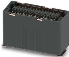
geschirmte SMD-Federleiste, Nennstrom: 1,7 A, Prüfspannung: 500 V AC, Polzahl: 32, Rastermaß: 0,8 mm, Farbe: schwarz, Kontaktoberfläche: Au, Kontaktart: Buchse, Montage: SMD-Löten
