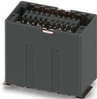
geschirmte SMD-Federleiste, Nennstrom: 1,7 A, Prüfspannung: 500 V AC, Polzahl: 20, Rastermaß: 0,8 mm, Farbe: schwarz, Kontaktoberfläche: Au, Kontaktart: Buchse, Montage: SMD-Löten
