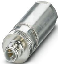
Power-Steckverbinder, Leistung, 5-polig, ungeschirmt, Stecker gerade M12, Kodierung: L, Push-Lock-Federanschluss, Rändelmaterial: Messing, vernickelt, Leitungsaußendurchmesser 8 mm ...
