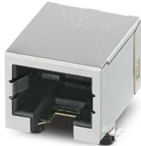
RJ45-Leiterplatten-Steckverbinder, Polzahl: 8, 10 GBit/s, SMD-Löten, Schutzart: IP20, Anschlussart: SMD-Reflow, Tape and Reel
