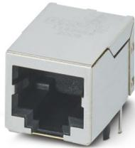
RJ45-Leiterplatten-Steckverbinder, Polzahl: 8, 10 GBit/s, Wellenlöt, Schutzart: IP20, Anschlussart: THT-Welle, Tray
