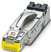
RJ45-Steckverbinder, Bauform: RJ45, Schutzart: IP20, Polzahl: 8, 10 GBit/s, CAT6<sub>A</sub>, Material: Metall, Anschlussart: Schneidklemmanschluss, Anschlussquerschnitt: AWG 26- 24, Kabelabgang: gerade, Farbe: gelb, Ethernet
