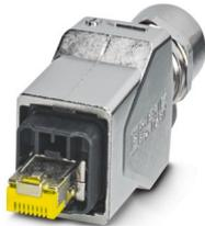
RJ45-Steckverbinder, Schutzart: IP65/IP67, Polzahl: 8, 10 GBit/s, CAT6<sub>A</sub>, Anschlussart: IDC-Schnellanschluss, Anschlussquerschnitt: AWG 23- 22, Kabelabgang: gerade, Ethernet
