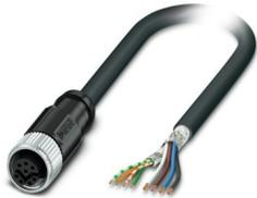
Hybridkabel, Ethernet Hybrid CAT5 (100 MBit/s), 8-polig, PUR halogenfrei, schwarz RAL 9005, geschirmt (Advanced Shielding Technology), Buchse gerade M12, Kodierung: Y / IP65/IP67, auf freies Leitungsende, Kabellänge: 5 m, Power with Ethernet (PWE)
