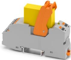
Relaismodul mit Push-in-Anschluss, bestehend aus: Relaissockel mit Status-LED, Freilaufdiode und Haltebügel, Sicherheitsrelais mit zwangsgeführten Kontakten gemäß DIN EN 61810-3, Kontaktausführung: 3 Schließer und 1 Öffner, Eingangsspannung: 24 V DC
