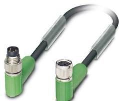
Sensor-/Aktor-Kabel, 4-polig, PUR halogenfrei, schwarzgrau RAL 7021, geschirmt, Stecker gewinkelt M8, Kodierung: A, auf Buchse gewinkelt M8, Kabellänge: 0,5 m
