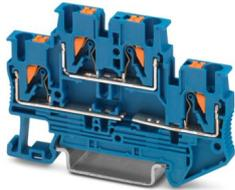
Bauelementreihenklemme, zum Einbau von selbst wählbaren Bauelementen, Nennspannung: 500 V, Nennstrom: 22 A, Anschlussart: Push-in-Anschluss, Bemessungsquerschnitt: 2,5 mm<sup>2</sup>, Querschnitt: 0,14 mm<sup>2</sup> - 4 mm<sup>2</sup>, Montageart: NS 35/7,5, NS 35/15, Farbe: blau
