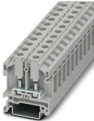
Bolzenanschlussklemme, Nennspannung: 1000 V, Nennstrom: 41 A, Anschlussart: Bolzenanschluss, Bemessungsquerschnitt: 6 mm<sup>2</sup>, Querschnitt: 0,5 mm<sup>2</sup> - 6 mm<sup>2</sup>, Montageart: NS 35/7,5, NS 35/15, Farbe: grau
