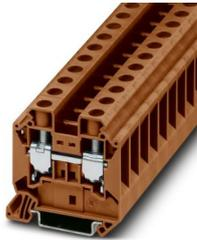
Durchgangsklemme, Nennspannung: 1000 V, Nennstrom: 76 A, Anzahl der Anschlüsse: 2, Anschlussart: Schraubanschluss, Bemessungsquerschnitt: 16 mm<sup>2</sup>, Querschnitt: 1,5 mm<sup>2</sup> - 25 mm<sup>2</sup>, Montageart: NS 35/7,5, NS 35/15, Farbe: braun
