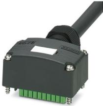
Anschlusshaube, Anwendung: Sensor-/Aktor-Box, Anzahl der Steckplätze: 4, Steckplatzbelegung: doppelt, Statusanzeige: nein; Stammleitungsanschluss: Steckbarer Schraubanschluss 180°, PUR/PVC, Leitungslänge: 20 m, Schirmung: nein
