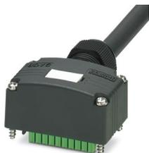
Anschlusshaube, Anwendung: Sensor-/Aktor-Box, Anzahl der Steckplätze: 8, Steckplatzbelegung: einfach, Statusanzeige: nein; Stammleitungsanschluss: Steckbarer Schraubanschluss 180°, PUR/PVC, Leitungslänge: 30 m, Schirmung: nein
