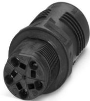
Wanddurchführung, Anschlussart: Push-in-Anschluss, Polzahl: 4+PE, M25, Stift, 1 mm<sup>2</sup> ... 2,5 mm<sup>2</sup>, 690 V, 20 A, PA, schwarz, ohne QUICKON-Mutter, Kodierung: kodiert, Leitungsaußendurchmesser: 6 mm ... 11 mm
