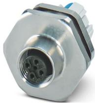
Wanddurchführung, Universal, 4-polig, ungeschirmt, Buchse gerade M12, Kodierung: A, Vorderwandmontage, M20 x 1,5, Push-Lock-Federanschluss, Rändelmaterial: Messing, vernickelt, Flachmutter beiliegend
