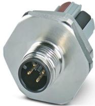
Wanddurchführung, Universal, 4-polig, ungeschirmt, Stecker gerade M12, Kodierung: A, Vorderwandmontage, M20 x 1,5, Push-Lock-Federanschluss, Rändelmaterial: Messing, vernickelt, Flachmutter beiliegend
