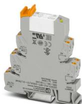
PLC-INTERFACE gegen Störströme bzw. Störspannungen auf der Steuerseite. Bestehend aus Grundklemme mit Push-in-Anschluss und steckbarem Miniaturrelais mit Leistungskontakt, 2 Wechsler, Eingangsspannung 230 V AC
