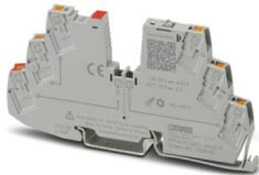
1-kanalige, elektronische Sicherung zum Schutz von 24 V-Verbrauchern. Einfache Potenzialverteilung mit Reihenklammern aus dem System CLIPLINE complete. Mit Statusausgang, Reseteingang und elektronischer Verriegelung. Zur Installation auf DIN-Tragschienen.
