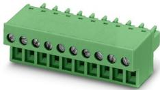
Leiterplattenstecker, Nennquerschnitt: 1,5 mm<sup>2</sup>, Farbe: grün, Nennstrom: 8 A, Bemessungsspannung (III/2): 160 V, Kontaktoberfläche: Sn, Kontaktart: Buchse, Anzahl der Reihen: 1, Polzahl: 5, Artikelfamilie: FRONT-MC 1,5/..-ST, Rastermaß: 3,81 mm, Anschlussart: Frontschraubanschluss, Schraubenangriffsform: L Längsschlitz, Anschlussrichtung Leiter/Platine: 0 °, Stecksystem: COMBICON MC 1,5, Verriegelung: ohne, Befestigungsart: ohne, Verpackungsart: verpackt im Karton
