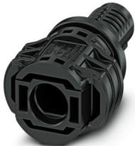
Gerätesteckverbinder Vorderwand, Artikelfamilie: SUNCLIX, Farbe: schwarz, Polzahl: 1, Aderquerschnitt min.: 2,5 mm<sup>2</sup>, Aderquerschnitt max.: 6 mm<sup>2</sup>, Bemessungsspannung: 1500 V DC, Bemessungsstrom: 38 A, Anschlussart: Crimp
