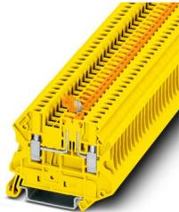
Messertrennklemme, Nennspannung: 400 V, Nennstrom: 20 A, Anschlussart: Schraubanschluss, Bemessungsquerschnitt: 2,5 mm<sup>2</sup>, Querschnitt: 0,14 mm<sup>2</sup> - 4 mm<sup>2</sup>, Montage: NS 35/7,5, NS 35/15, Farbe: gelb
