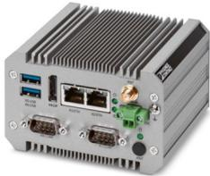
Lüfterloser Industrie-Box-PC (BPC) mit Schutzart IP30 mit energieeffizientem Intel® Celeron® N3350-Prozessor, 32 GB eMMC-Massenspeicher, einem offenen M.2-Steckplatz und 2x COM-Ports
