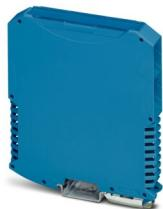
Tragschienengehäuse, Komplettgehäuse mit Metallfußriegel, hohe Bauform, mit Lüftungsschlitz, Breite: 17,6 mm, Höhe: 99 mm, Tiefe: 113,65 mm, Farbe: blau (ähnlich RAL 5015), Querverbindung: Tragschienen-Busverbinder (optional), Polzahl Querverbinder: 5
