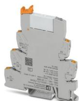
PLC-INTERFACE gegen Störströme bzw. Störspannungen auf der Steuerseite. Bestehend aus Grundklemme PLC-BPT-120UC/21/SO46 mit Push-in-Anschluss und steckbarem Miniaturrelais mit Leistungskontakt bis 6 A, 1 Wechsler, Eingangsspannung 120 V AC
