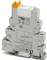
PLC-INTERFACE gegen Störströme bzw. Störspannungen auf der Steuerseite. Bestehend aus Grundklemme PLC-BSC-120UC/21-21/SO46 mit Schraubanschluss und steckbarem Miniaturrelais mit Leistungskontakt bis 2x 8 A, 2 Wechsler, Eingangsspannung 120 V AC
