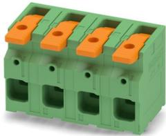
Leiterplattenklemme, Nennstrom: 76 A, Bemessungsspannung (III/2): 1000 V, Nennquerschnitt: 16 mm<sup>2</sup>, Anzahl der Potenziale: 4, Anzahl der Reihen: 1, Polzahl pro Reihe: 4, Artikelfamilie: LPT 16/, Rastermaß: 15 mm, Anschlussart: Hebel-Push-in-Anschluss, Montage: Wellenlöten, Anschlussrichtung Leiter/Platine: 0 °, Farbe: grün, Pin-Layout: Zick-Zack-Pinning W, Pinlänge [P]: 3,6 mm, Verpackungsart: verpackt im Karton
