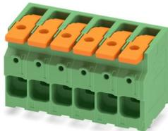
Leiterplattenklemme, Nennstrom: 76 A, Bemessungsspannung (III/2): 1000 V, Nennquerschnitt: 16 mm<sup>2</sup>, Anzahl der Potenziale: 6, Anzahl der Reihen: 1, Polzahl pro Reihe: 6, Artikelfamilie: LPT 16/, Rastermaß: 10 mm, Anschlussart: Hebel-Push-in-Anschluss, Montage: Wellenlöten, Anschlussrichtung Leiter/Platine: 0 °, Farbe: grün, Pin-Layout: Zick-Zack-Pinning W, Pinlänge [P]: 3,6 mm, Verpackungsart: verpackt im Karton
