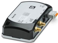
WLAN Access Point, Client, Mesh mit 2 externen Antennenanschlüssen (RSMA-F), IP20, Temperaturbereich: -40 °C ... +60 °C, WLAN 802.11a, b, g, n, Frequenz: 2,4 GHz, 5 GHz, Anschlüsse: COMBICON 9 V DC ... 32 V DC, RJ45: für LAN, Web, http/https, CLI, REST-API
