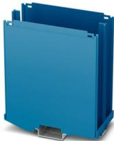
Tragschienengehäuse, Gehäuseunterteil mit Metallfußriegel, Breite: 50,1 mm, Höhe: 100 mm, Tiefe: 108,35 mm, Farbe: blau (ähnlich RAL 5015), Querverbindung: Tragschienen-Busverbinder (optional), Polzahl Querverbinder: 8
