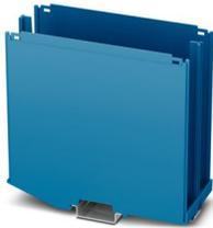
Tragschienengehäuse, Gehäuseunterteil mit Metallfußriegel, Breite: 50,1 mm, Höhe: 122,5 mm, Tiefe: 108,35 mm, Farbe: blau (ähnlich RAL 5015), Querverbindung: Tragschienen-Busverbinder (optional), Polzahl Querverbinder: 8
