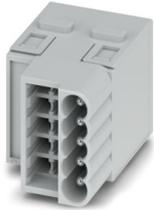
Kontakteinsatzmodul, Polzahl: 5, Leistungskontakte: 5, Stift, Push-in-Anschluss, 400 V, 16 A, 0,5 mm<sup>2</sup> ... 2,5 mm<sup>2</sup>, Anwendung: Leistung, mit doppeltem Funktionsschacht für Brücken
