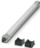
LED-Maschinenleuchte, 24 V DC, Abstrahlwinkel (vertikal/horizontal): 89 °/97 °, Länge: 615 mm, Durchmesser: 25 mm, Schutzart: IP54, schwenkbar
