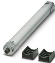
LED-Maschinenleuchte, 24 V DC, Abstrahlwinkel (vertikal/horizontal): 85 °/101 °, Länge: 615 mm, Durchmesser: 35 mm, Schutzart: IP54, schwenkbar, Dimmung, in Serie schaltbar
