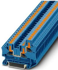
Durchgangsklemme, Nennspannung: 1000 V, Nennstrom: 41 A, Anzahl der Anschlüsse: 3, Polzahl: 1, Anschlussart: Push-in-Anschluss, Bemessungsquerschnitt: 6 mm<sup>2</sup>, Querschnitt: 0,5 mm<sup>2</sup> - 10 mm<sup>2</sup>, Montageart: NS 35/7,5, NS 35/15, Farbe: blau
