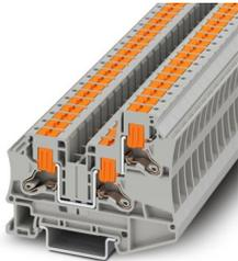
Durchgangsklemme, Nennspannung: 1000 V, Nennstrom: 41 A, Anzahl der Anschlüsse: 3, Polzahl: 1, Anschlussart: Push-in-Anschluss, Bemessungsquerschnitt: 6 mm<sup>2</sup>, Querschnitt: 0,5 mm<sup>2</sup> - 10 mm<sup>2</sup>, Montageart: NS 35/7,5, NS 35/15, Farbe: grau
