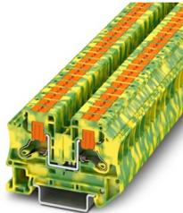
Schutzleiter-Reihenklemme, Anzahl der Anschlüsse: 2, Polzahl: 1, Anschlussart: Push-in-Anschluss, Bemessungsquerschnitt: 6 mm<sup>2</sup>, Querschnitt: 0,5 mm<sup>2</sup> - 10 mm<sup>2</sup>, Montageart: NS 35/7,5, NS 35/15, Farbe: grün-gelb
