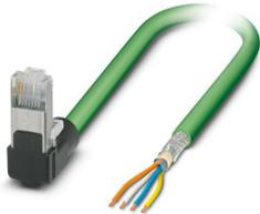
Patch-Kabel, RJ45/IP20 oben, Kabellänge: 1 m, Polzahl: 4, 100 MBit/s, CAT5, Anschlussart: Pierce-Anschluss, PROFINET, 1x4xAWG22/7, SF/TQ, grün RAL 6018
