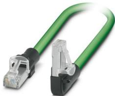
Patch-Kabel, RJ45/IP20 gerade auf RJ45/IP20 rechts, Kabellänge: 0,5 m, Polzahl: 4, 100 MBit/s, CAT5, 1x4xAWG22/7, SF/TQ, grün RAL 6018
