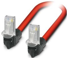
Patch-Kabel, RJ45/IP20 unten auf RJ45/IP20 unten, Kabellänge: 1 m, Polzahl: 4, 100 MBit/s, CAT5, PROFINET, 1x4xAWG22/7, SF/TQ, verkehrsrot RAL 3020
