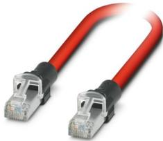
Patch-Kabel, RJ45/IP20 gerade auf RJ45/IP20 gerade, Kabellänge: 0,3 m, Polzahl: 4, 100 MBit/s, CAT5, Anschlussquerschnitt: AWG 23- 22, PROFINET, 1x4xAWG22/7, SF/TQ, verkehrsrot RAL 3020
